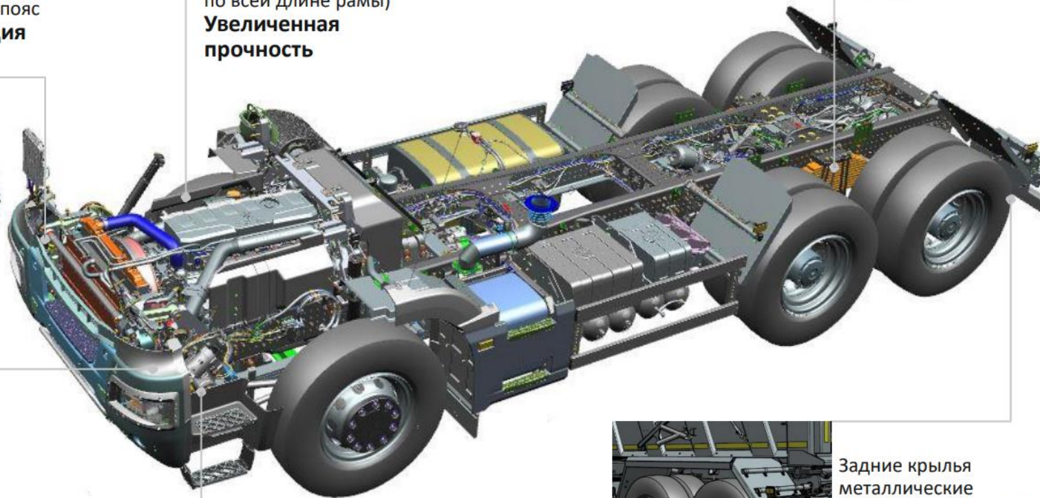
Модернизированная задняя подвеска под нагрузку 32 тонны Стремянки установлены резьбовой частью вверх
