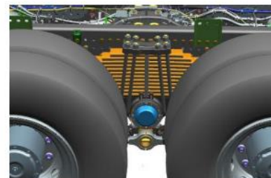
Модернизированная задняя подвеска под нагрузку 32 тонны Стремянки установлены резьбовой частью вверх
