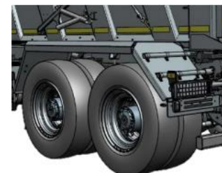
Задние крылья металлические с интегрированными фонарями
