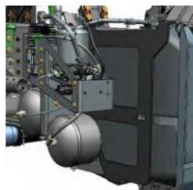
Блок подготовки воздуха перенесен в базу и расположен высоко за баком AdBlue Удобство обслуживания
